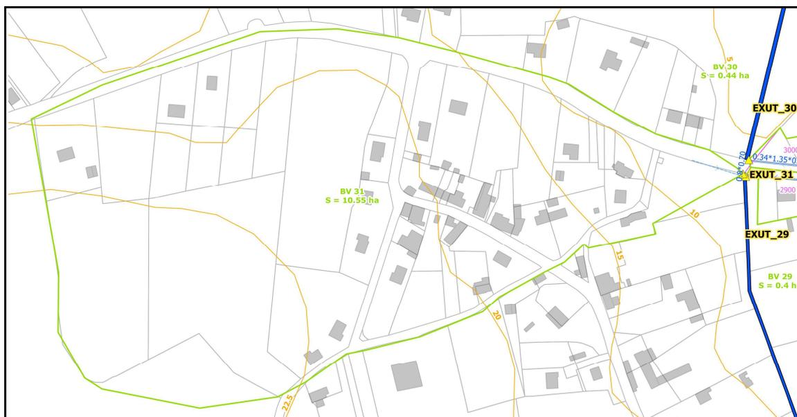
**Figure 11 : Réseau pluvial et bassins versants, exutoire 31**
