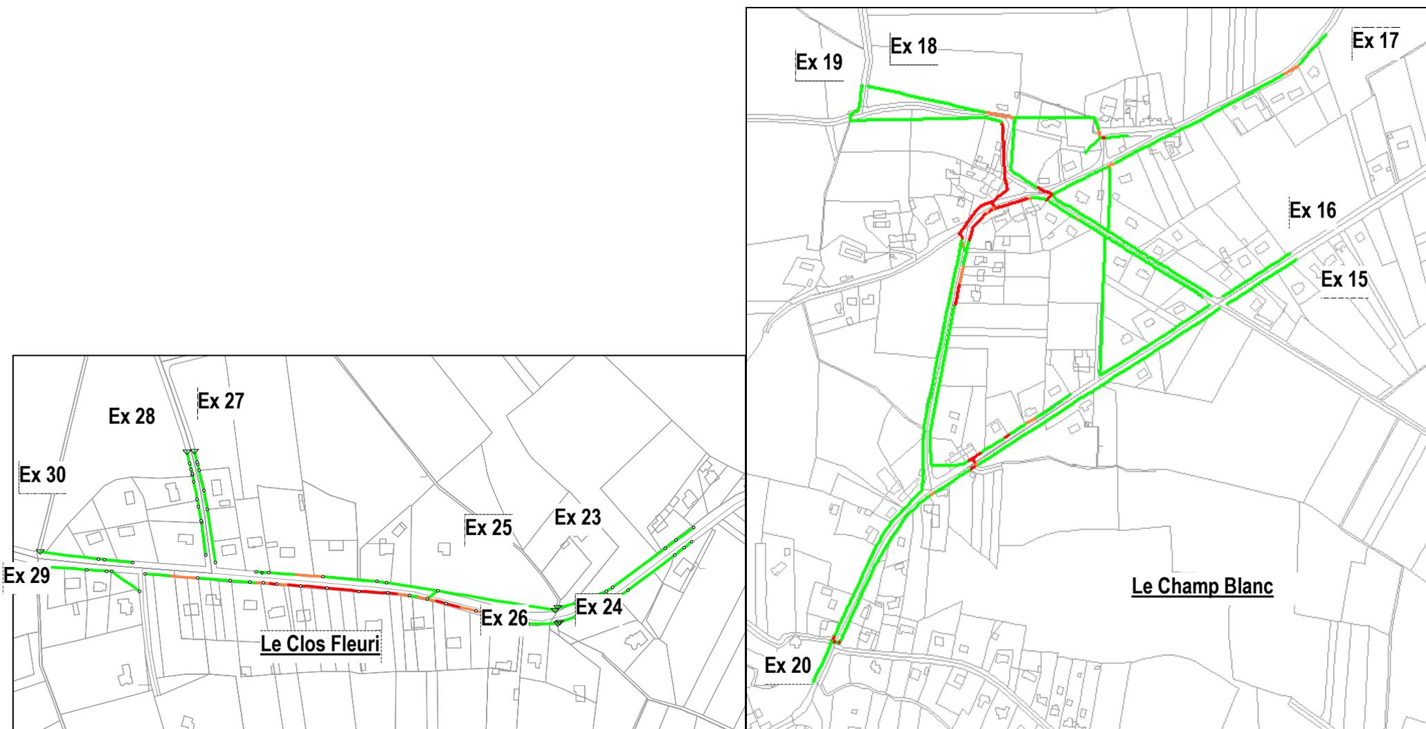
**Figure 18 : Taux de remplissage des conduites et absence de débordements pour une pluie décennale en situation projet – Secteur des hameaux**
